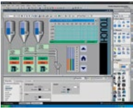
WinCC HMI Projelendirme
